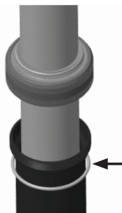
Junta tórica de retención del collarín
