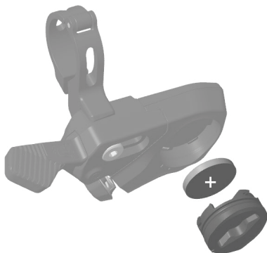
Désinstallation de la pile
