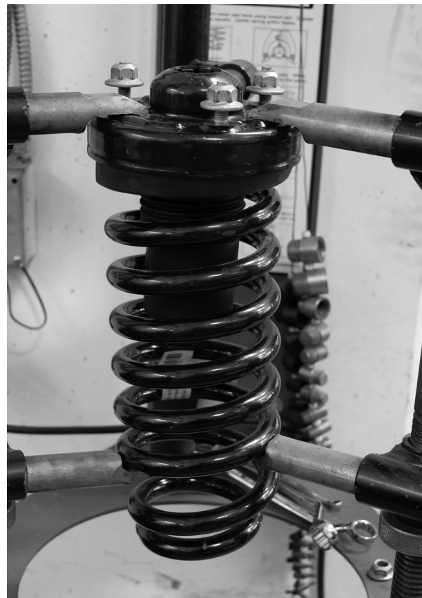
Fig. 9: Remove the center nut.
