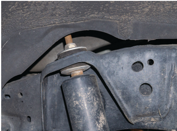
Fig. 20: Remove stem top nut.
