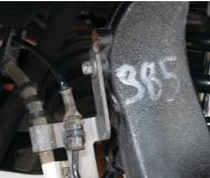
Fig. 23: Brake bracket bolt.
