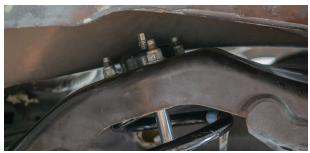
Fig. 28: Attach the top hat nuts.
