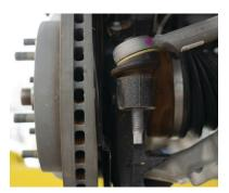
Fig. 2: Tie rod end link.
