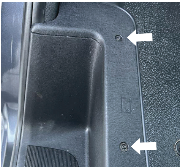
Fig. 9: Remove door step trim.
