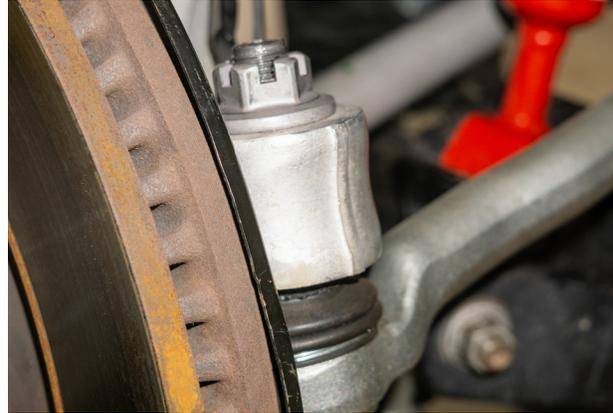
Fig. 14: Tie rod end link.
