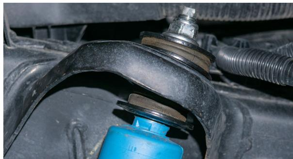
Fig. 17: Remove stem top nut.
