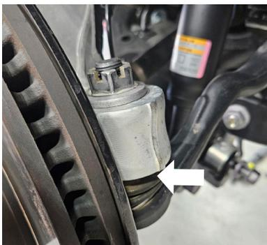
Fig. 1: Tie rod end link.
