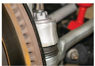
Fig. 14: Tie rod end link.
