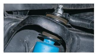
Fig. 17: Remove stem top nut.
