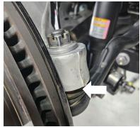
Fig. 1: Tie rod end link.
