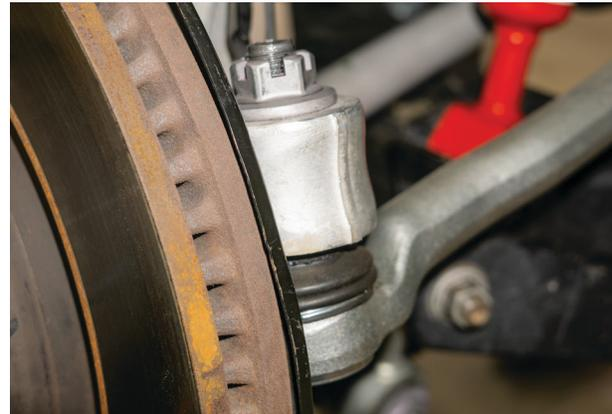
Fig. 12: Tie rod end link.
