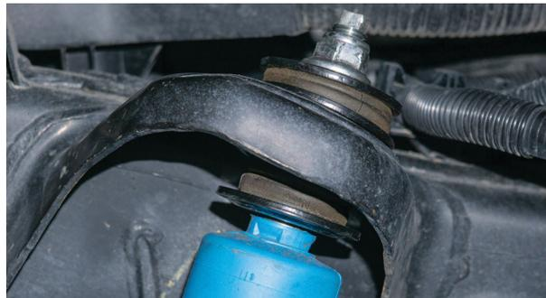
Fig. 17: Remove stem top nut.
