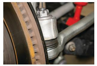
Fig. 8: Tie rod end link.
