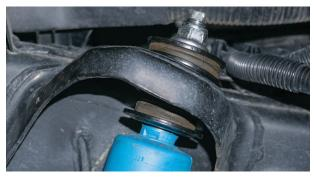
Fig. 10: Remove stem top nut.
