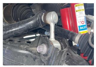
Fig. 9a: Sway bar end link (non-KDSS).
