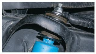
Fig. 10: Remove stem top nut.
