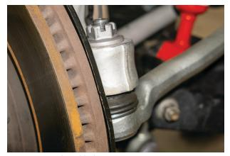
Fig. 8: Tie rod end link.
