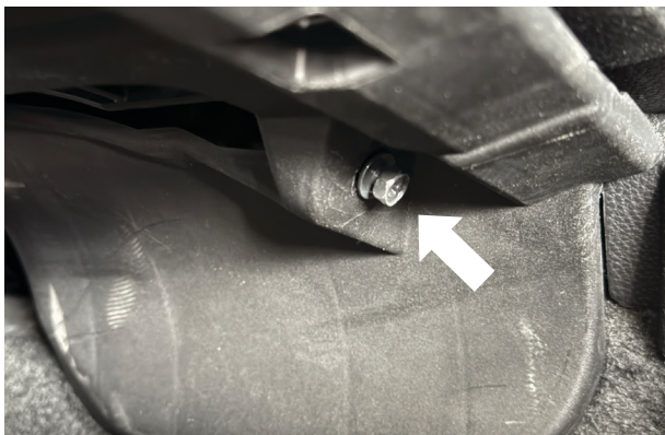
Fig. 17: Remove bolt under trim.
