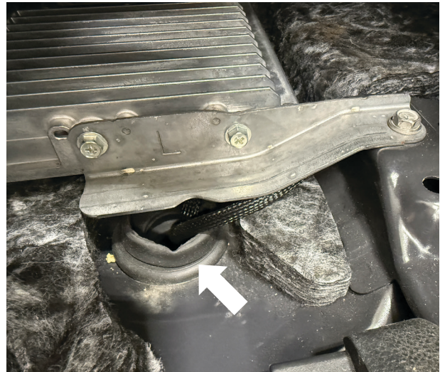
Fig. 51: Locate OE grommet under carpet.
