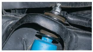
Fig. 28: Remove stem top nut.
