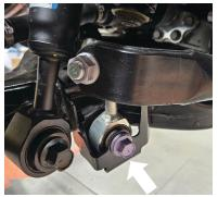
Fig. 2a: Sway bar end link (w/KDSS)
