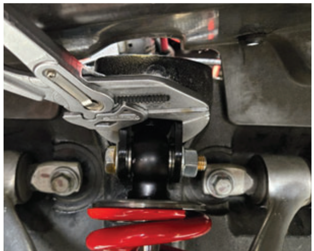
Fig. 17: Torque top mount.
