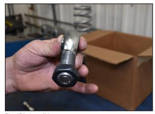
Fig. 17A: Install jam nut.
