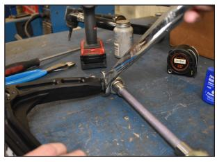
Fig. 20B: Tighten jam nut.
