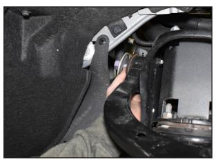
Fig. 16A: Remove UCA Bolt.
