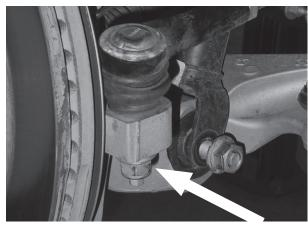
Fig. 3: Remove tie rod end nut.
